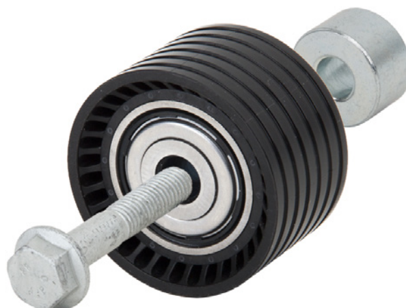
Imagen 2: 532 0654 10 – Polea de inversión con el nuevo concepto de sellado y piezas adicionales
