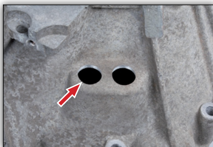
Fig. 6: Desbarbado y limpieza
