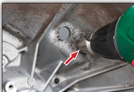
Fig. 5: Ampliación de los orificios con un taladro
