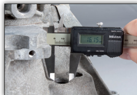
Fig. 2: Si el diámetro es menor de 21 mm, se deben ampliar los orificios con un taladro hasta que alcancen un mínimo de 21 mm y un máximo de 24 mm.
