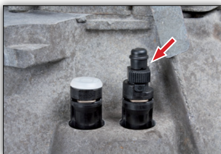
Fig. 8: Se puede accionar la boquilla de purga con la mano o con una llave de boca (ancho de llave: 13)
