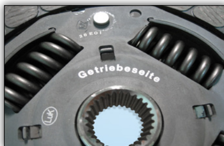
Fig. 1-4: posibles inscripciones sobre el disco de embrague.
